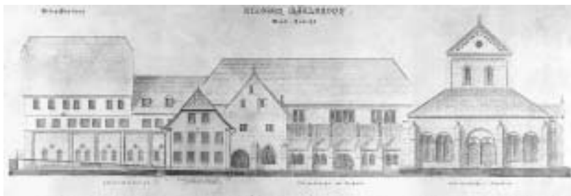
Abb. 6b: Ansicht des Westflügels vor dem Umbau. Die vorgelagerte Speisemeisterei und der Fachwerkaufbau des Oberamtsgerichtes sind mit Buchstaben für den Abbruch gekennzeichnet. 1891
