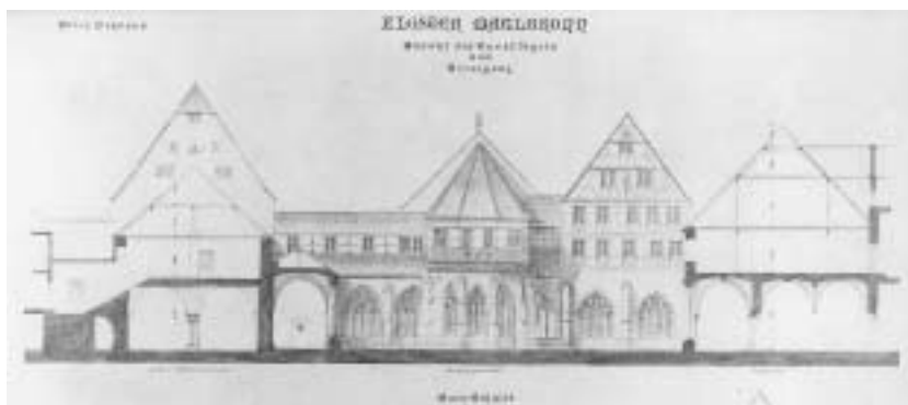
Abb. 8 a: Nordflügel des Klosters vor den Baumaßnahmen Ende des 19. Jahrhunderts, mit den Fachwerkaufbauten über dem Laienrefektorium und dem Kalefaktorium. August Berger 1891
